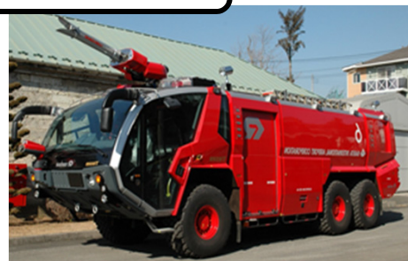
大型放水砲搭載ホース延長車
